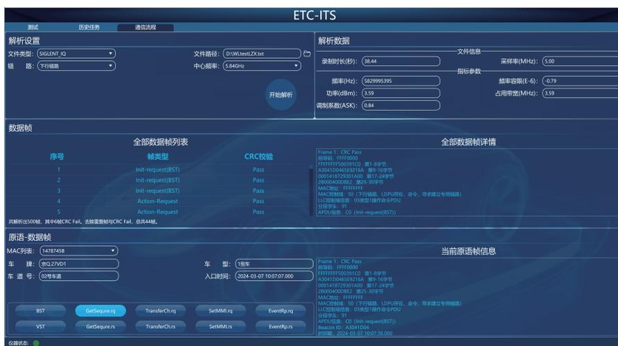
使用ETC综合测试仪连接接收天线录制OBU与RSU的交互过程,通过ETC交易过程分析软件ProEye对录制信号进行分析即可得到信号所包含的相关信息。
